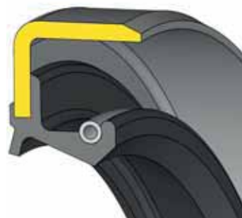
Serie/Série: BS .... Metallisches Gehäuse, mit Staublippe Boîtier métallique, avec lèvre anti-poussière
